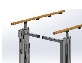
Fig. 2: De automatische platformbarrière (aanvullende voorziening) komt omhoog en wordt vergrendeld
